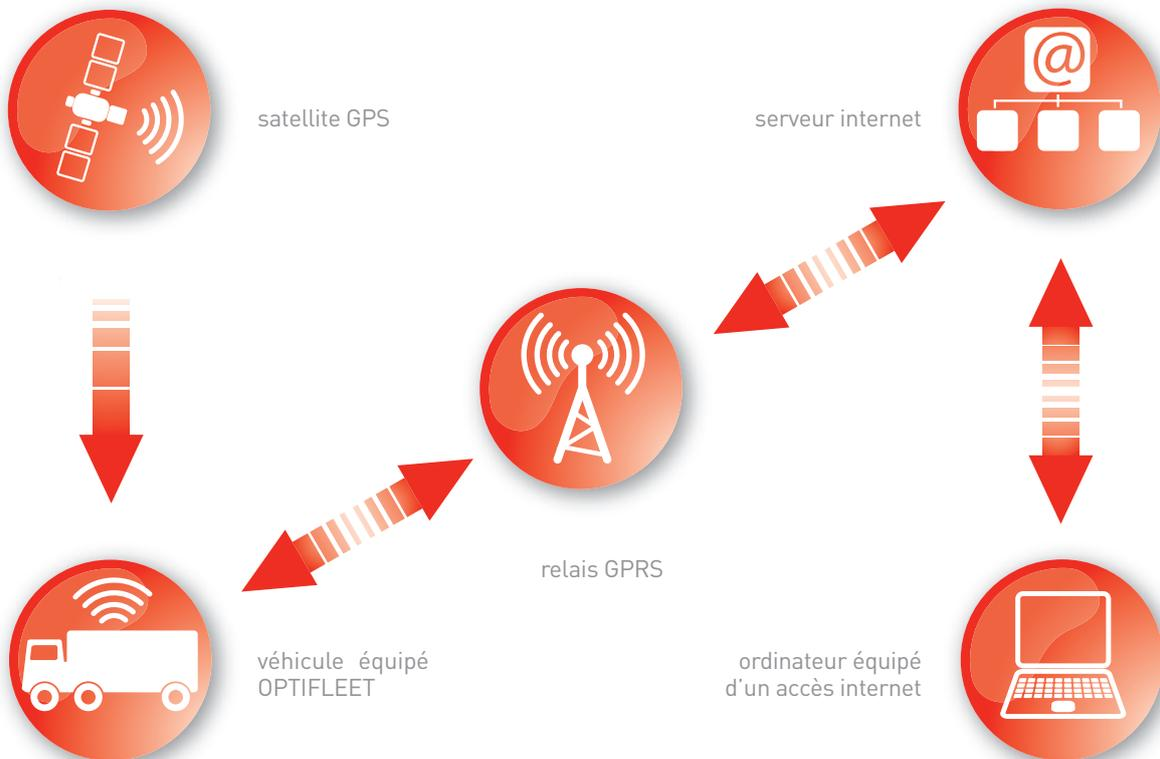
OPTIFLEET collecte la position GPS, l'activité tachygraphe et les données techniques du véhicule. Les informations collectées sont transmises et hébergées sur le serveur Renault Trucks. **L'exploitant accède aux informations en temps réel sur le site web [www.optifleet.net](http://www.optifleet.net)**
